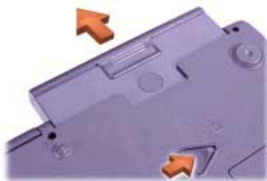
**6** Mocno wsuń nowy akumulator do wnęki akumulatora. Kliknięcie oznacza, że akumulator został prawidłowo umieszczony we wnęce.
