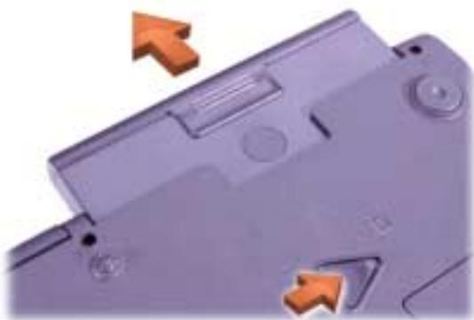
**6** С усилием вставьте новую батарею в аккумуляторный отсек. Когда она полностью войдет в отсек, должен послышаться щелчок.
